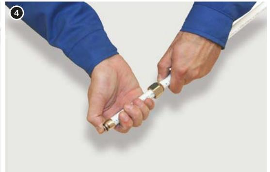
4. O corpo da união aparafusada (do tubo de ligação) inserir para o interior do tubo até sentir a resistência clara. A profundidade de inserção do tubo de ligação é de aprox. 9 mm para tubos  $\varnothing 14$ , 16, 20 e de 12 mm para tubos de  $\varnothing 25$  e 26.
